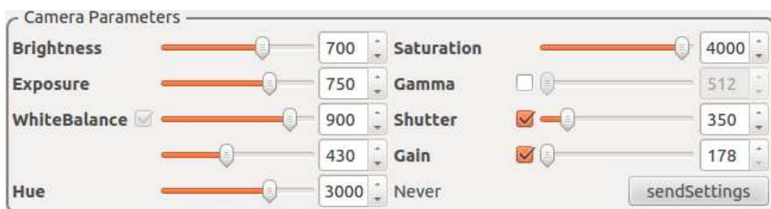
Abbildung 5.6.: Durch Schieberegler verstellbare Kameraparameter des ColorCalibrators.
