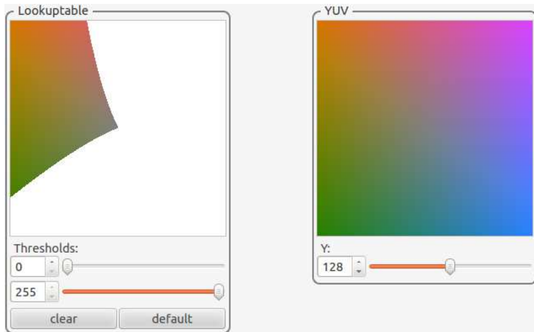
Abbildung 5.3.: Visuelle Darstellung der Umsetzungstabelle und des YUV-Farbraums. (Lookuptable) Farbwerte können ausgewählt und hinzugefügt werden. (YUV) YUV-Farbraum wird mit einstellbarer Luminanz dargestellt. Farbwerte können ausgewählt und zur Umsetzungstabelle hinzugefügt werden.
